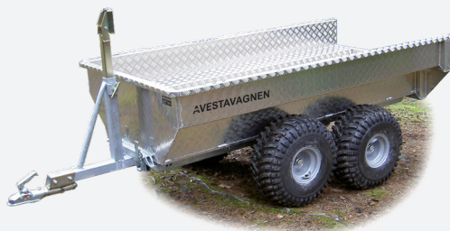
Utility Trailer utrustad med linstyrare på stolpe
